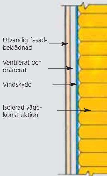
Två-steps tätning med luftad fasadbeklädnad
